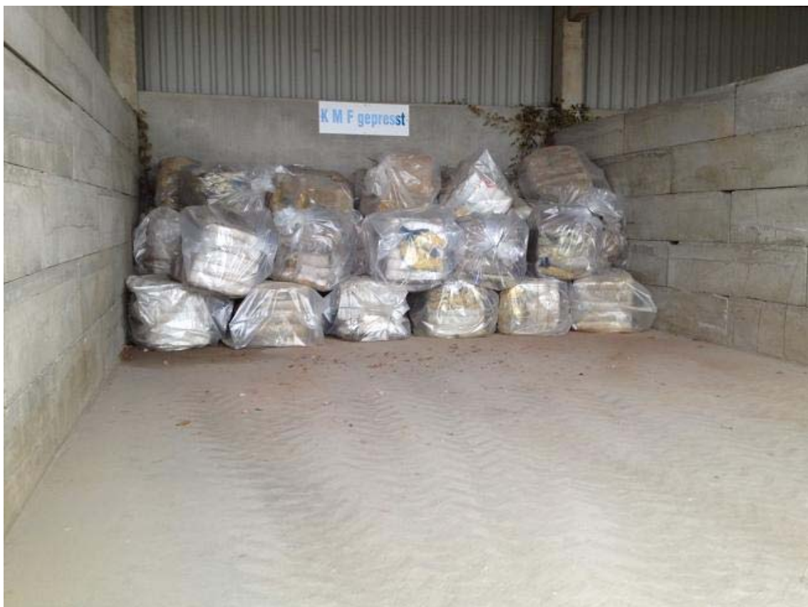
Bild 13: Lagerung der angelieferten KMF-Abfälle im Außenbereich
